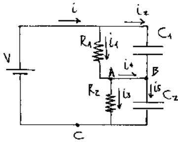
$$\begin{aligned} i &= i_1 + i_2 \\ i_1 &= i_3 + i_4 \\ i_5 &= i_4 + i_2 \\ i &= i_3 + i_5 \end{aligned}$$
