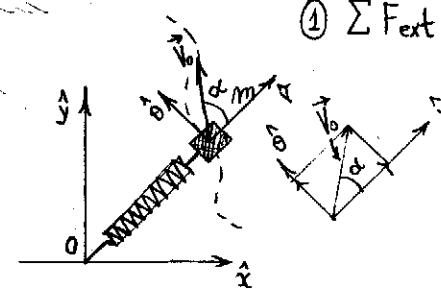
Sistema: masa, resorte, eje → masa despreciable
