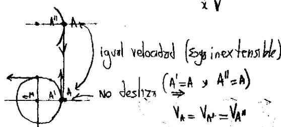
$$\vec{V}_{A''} = \vec{V}_{CM} + \vec{\omega}'' \times \vec{R}$$
